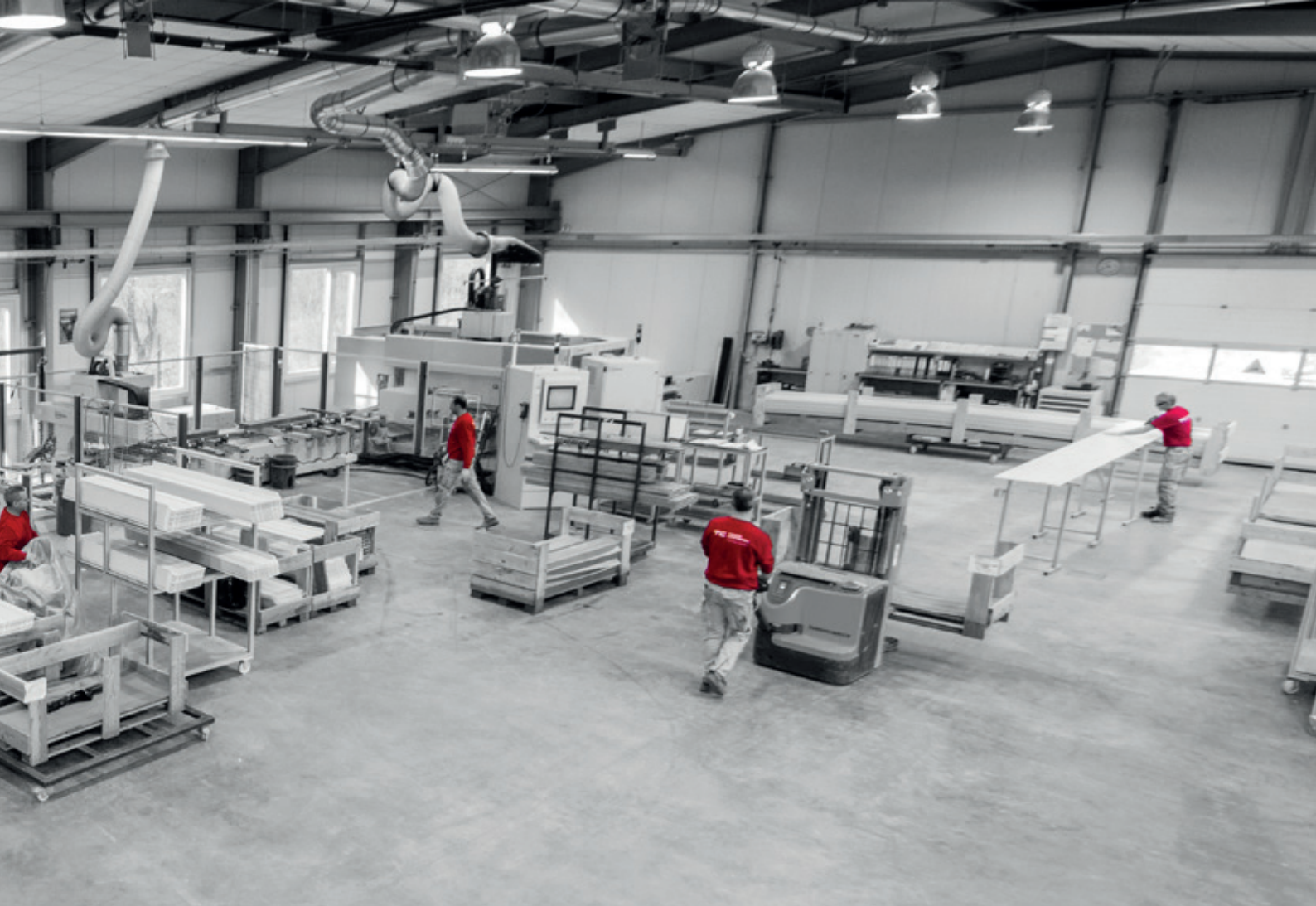
Blick in die Maschinenhalle der Techno-Composites Domine GmbH im niedersächsischen Meppen. Hier findet die CNC-Bearbeitung der GFK-Profile statt.
